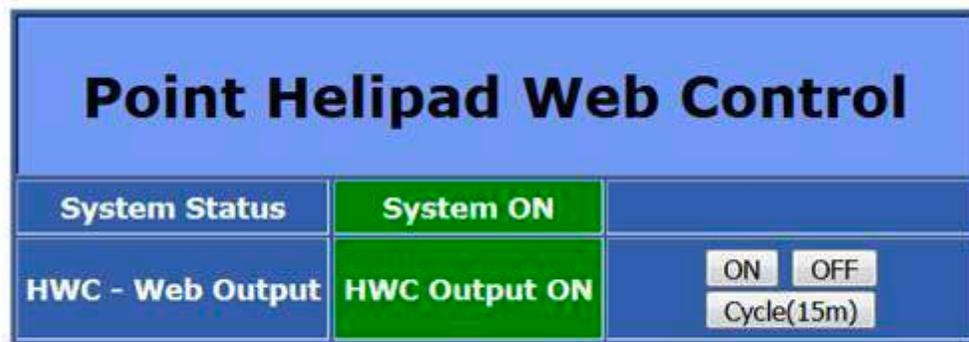
Cuando se muestre la posición del interruptor "Sistema apagado" en el PHC: el relevador HWC se apagará, el control mediante internet no funcionará y aparecerá el mensaje en rojo de "Salida HWC OFF" en el dispositivo.
