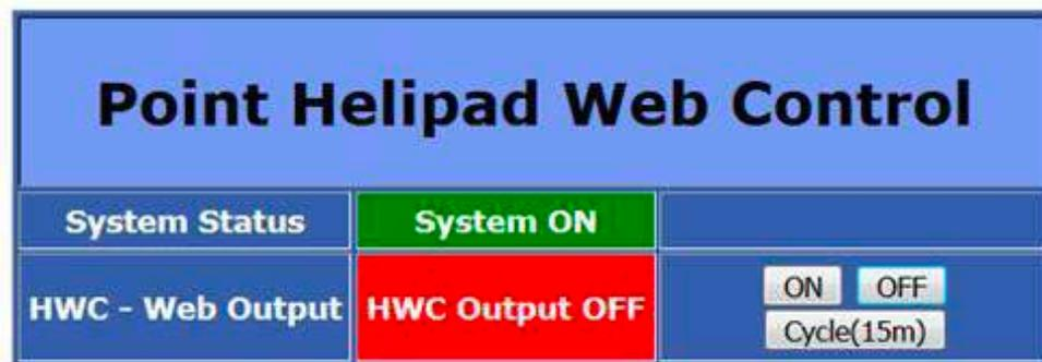
Cuando se muestre la posición del interruptor "ON" en el PHC: Este es el modo de anulación manual del sistema. El HWC tiene energía para que pueda ver que el sistema se ha habilitado de forma remota. Los circuitos de salida del PHC se controlan manualmente en el PHC. Se mostrará "Sistema ENCENDIDO" en color VERDE en el dispositivo remoto. "Salida HWC APAGADA" se mostrará en ROJO.
